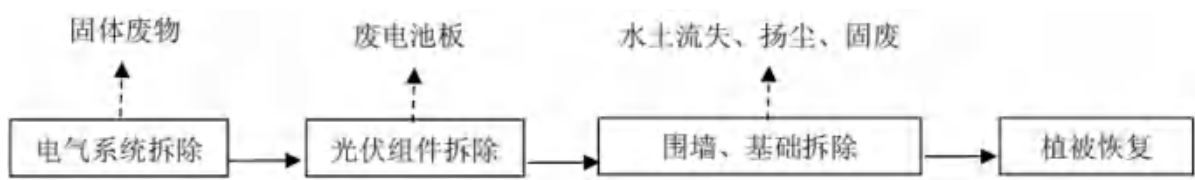
图 4.1-5 服务期满后拆除工序流程及排污节点
