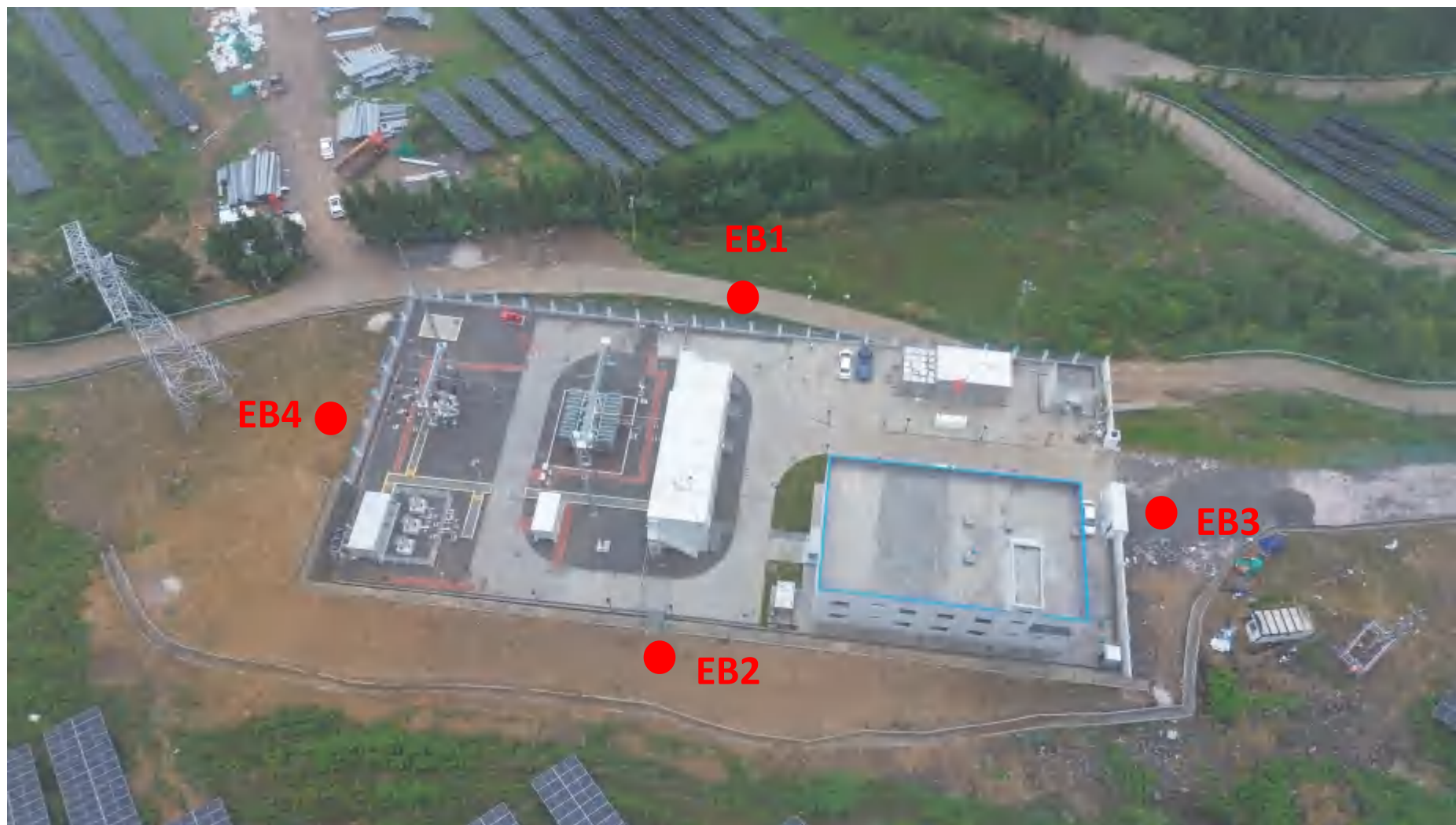
附图 8 升压站电磁辐射监测布点图
