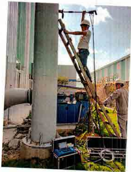
现场有组织废气采样图
